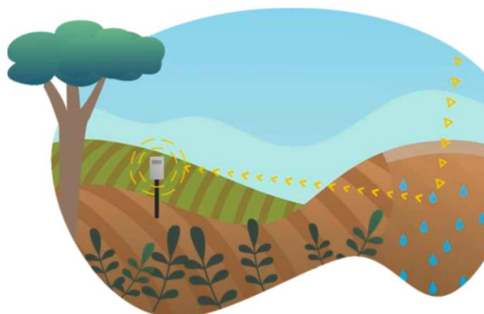
Figura 7. A sonda mede os nêutrons formados pela interação entre água e raios cósmicos
